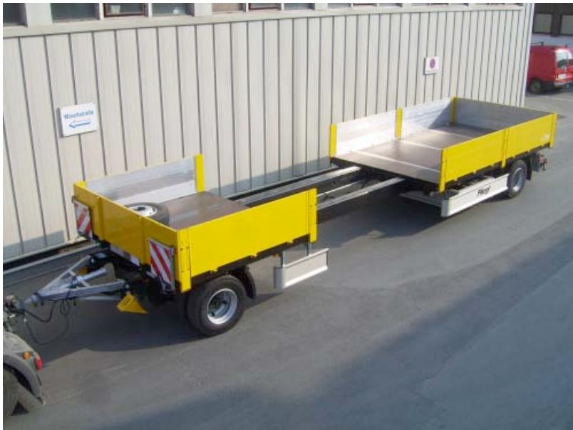
Гарантию безопасной перевозки груза обеспечивают достаточное количество крепежных колец в наружной раме, а также освещаемые предупредительные таблички. Прицеп-платформа от Fliegl оснащен бортами высотой 600 мм. При перевозки когда в них нет необходимости, борта можно снять и убрать в специально отведенное место для их складирования.
