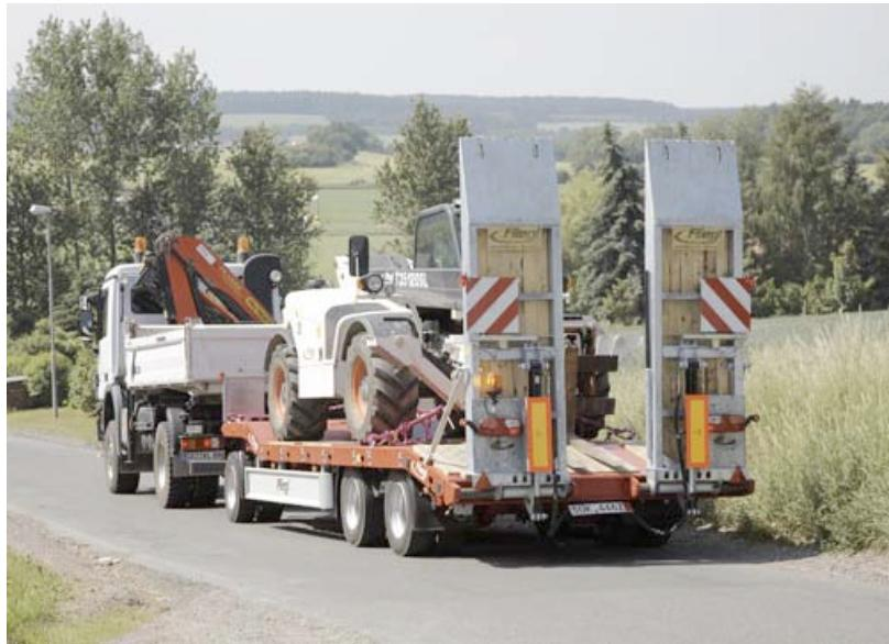
Для транспортировки строительной техники , оборудования и другого тяжелого груза Fliegl поставляет различные низкорамные прицепы, специально по пожеланиям клиентов как одно, двух или же с большим количеством осей. В соответствии с правилами дорожного
